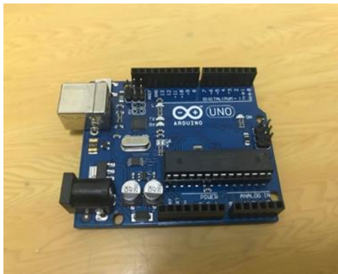
圖 1、ARDUINO UNO R3 開發版，是一塊基於開放原始代碼的 Simple i/o 平臺
